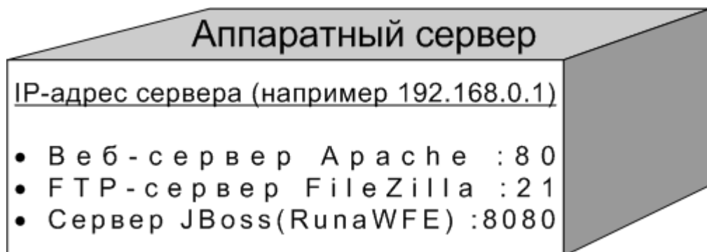
Рис. 6.5. – Структура программного обеспечения сервера.
