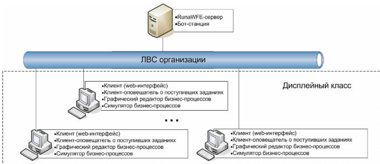
Рис. 6.6. – Схема взаимодействия между клиентами и сервером RunaWFE
